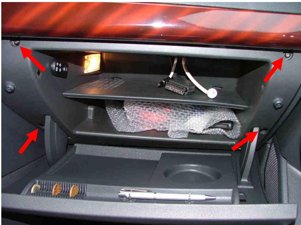
Bild 3: Ausbau des Handschuhfaches
