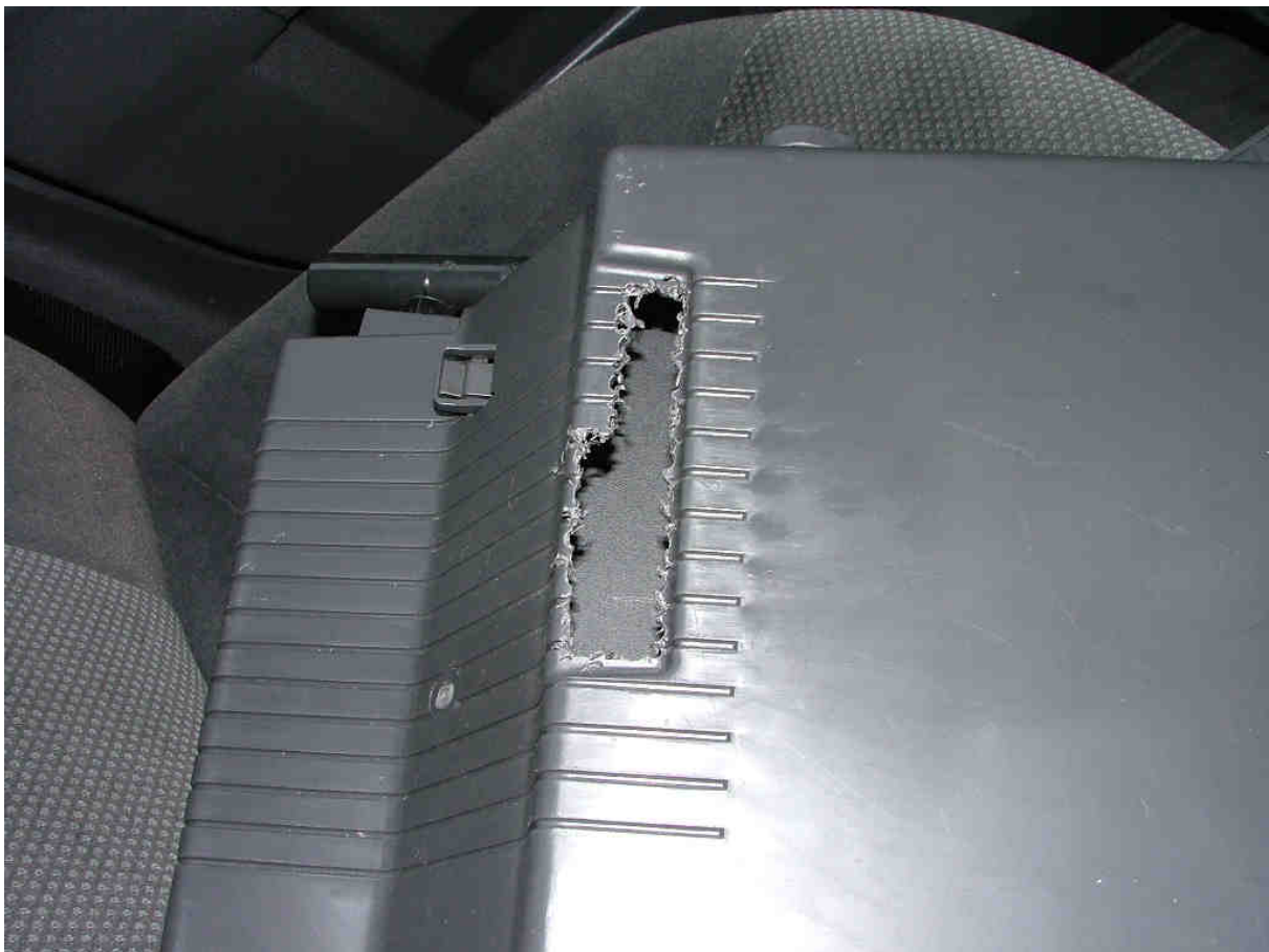
Bild 27: Aussparung im Handschuhfach zur Durchführung von diversen Kabeln
