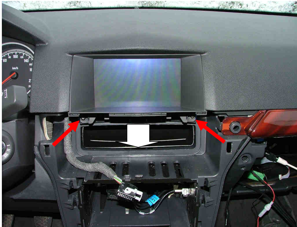
Bild 8: Ausbau des TFT-Displays (CID)
