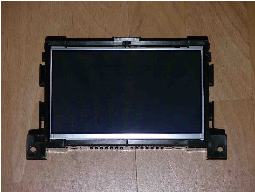
Bild 11: Ausgebautes Color Info Display
