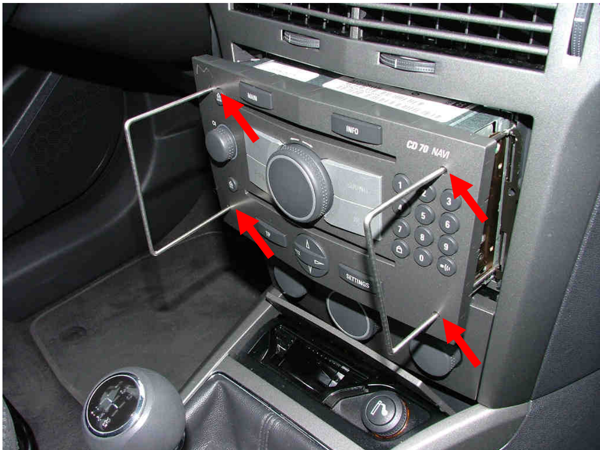
Bild 4: Ausbau der EHU
