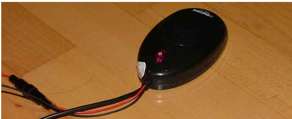
Bild 33: FM-Modulator mit Stromversorgungskabel und Chinch-Eingängen
