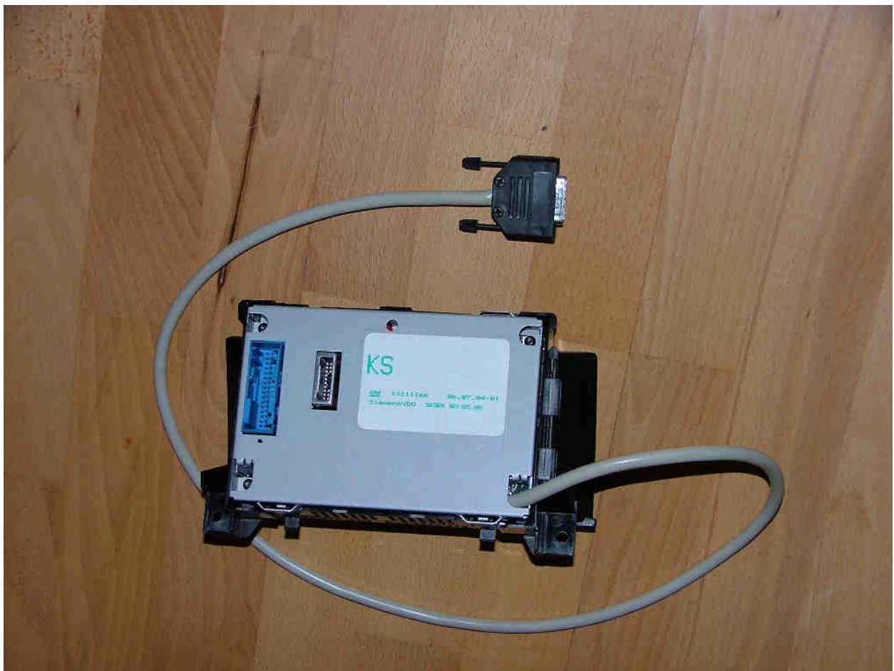
Bild 23: modifiziertes CID mit geschirmtem Videokabel
