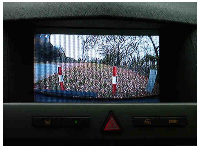
Rückfahrkamera über FBAS->RGB-Konverter
