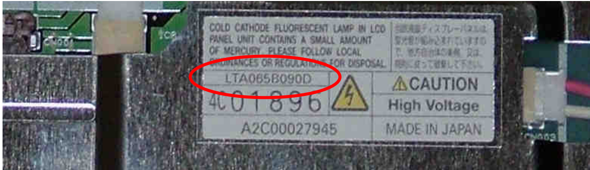
Bild 41: im CID verbautes TFT-Panel LTA065B090D
