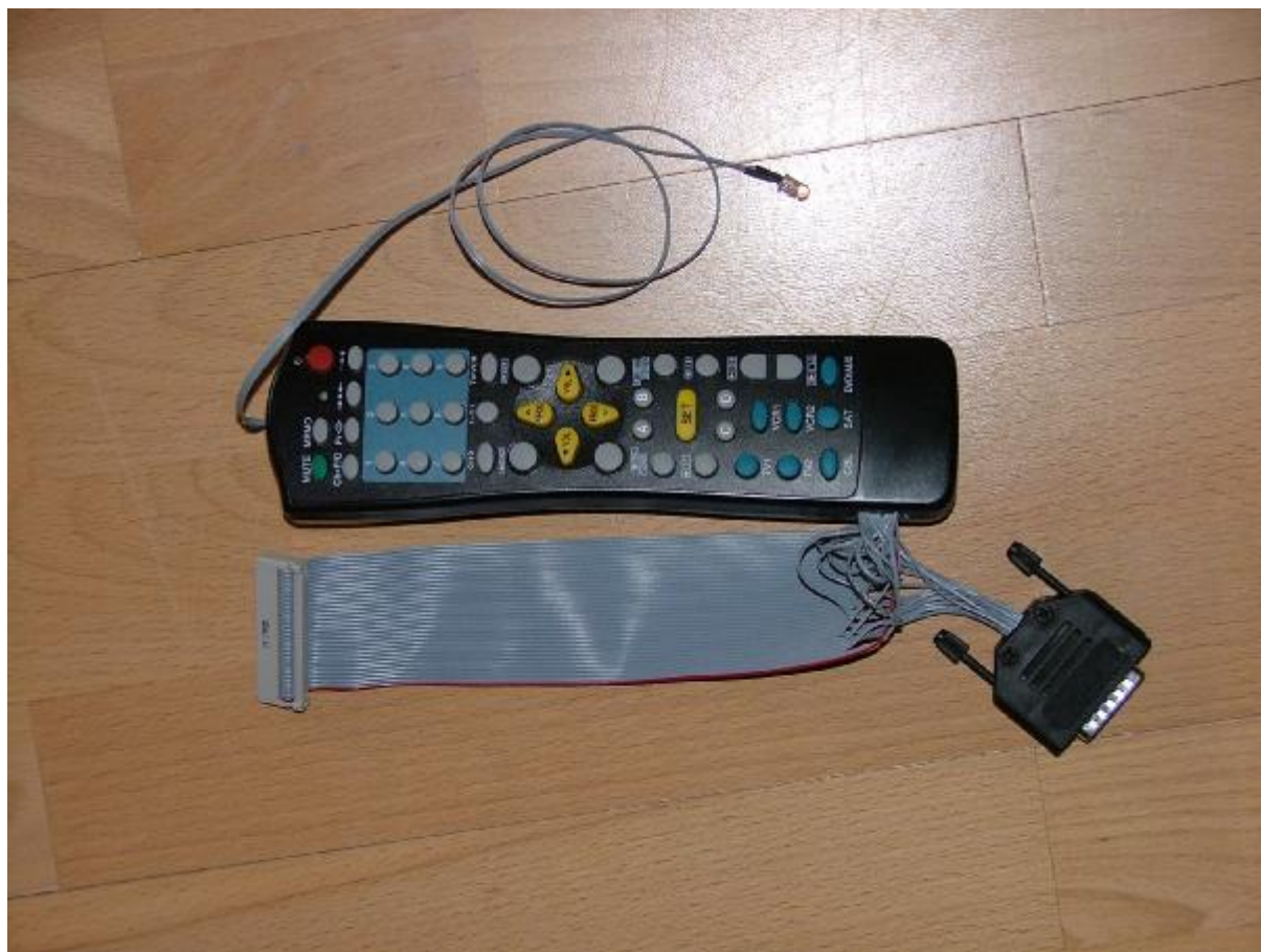
Bild 3: modifizierte IR-Fernbedienung mit Anschlusskabel
