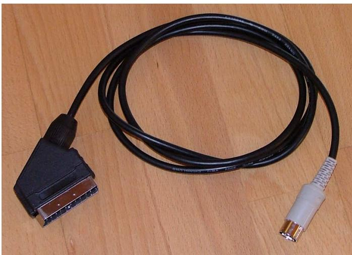
Bild 5: Adapterkabel 2 (SCART auf 5-pol. DIN)
