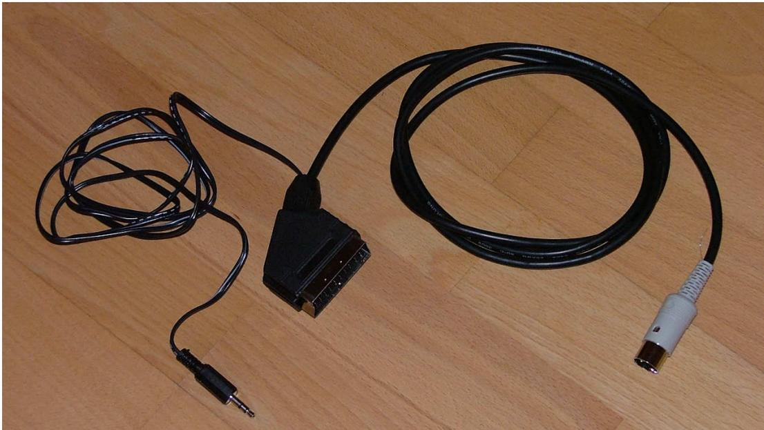
Bild 4: Adapterkabel 1 (SCART auf 5-pol. DIN mit Stereo-Klinkenstecker für Audioübertragung)
